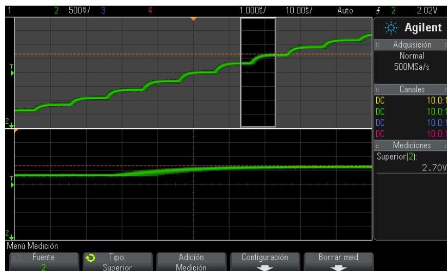
Imagen 45 Aislamiento de un área para medición Superior
