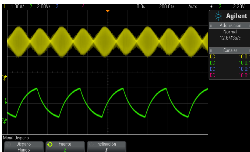
Imagen 26 Modulación de amplitud representada con intensidad del 40%
